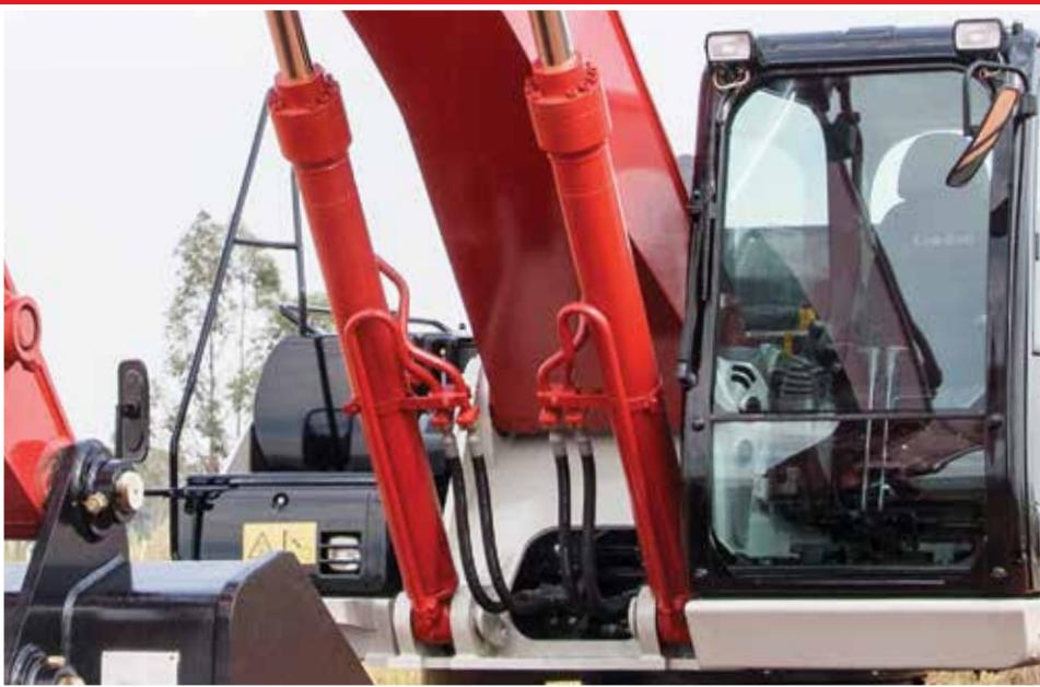
Resultado de um sistema hidráulico avançado, a 360X3E tem maior capacidade de escavação, maiores velocidades de giro e elevação simultâneas que proporcionam ciclos de trabalhos rápidos. O controle da válvula de centro aberto permite que o óleo hidráulico retorne ao tanque quando a válvula de controle está centralizada, o que proporciona uma sensação muito mais suave ao operar a máquina e elimina o excesso de pressão em todo o sistema. Isso também ajuda a economizar combustível.
