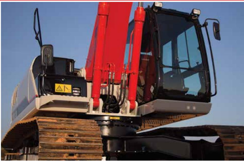
Resultado de um sistema hidráulico avançado, a 300X3E tem maior capacidade de escavação, maiores velocidades de giro e elevação simultâneas que proporcionam ciclos de trabalhos rápidos. O controle da válvula de centro aberto permite que o óleo hidráulico retorne ao tanque quando a válvula de controle está centralizada, o que proporciona uma sensação muito mais suave ao operar a máquina e elimina o excesso de pressão em todo o sistema. Isso também ajuda a economizar combustível.
