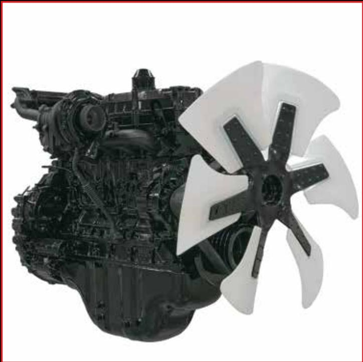
Com um motor especialmente desenvolvido para o modelo 300X3E, a nova série de escavadeiras Link-Belt apresenta uma versão mais robusta, mais eficiente e mais econômica do Isuzu 6HK1 com certificação equivalente Tier 3 EPA. Um motor mais robusto, desenvolvido para as condições severas da América Latina e com sistema eletrônico de proteção.
