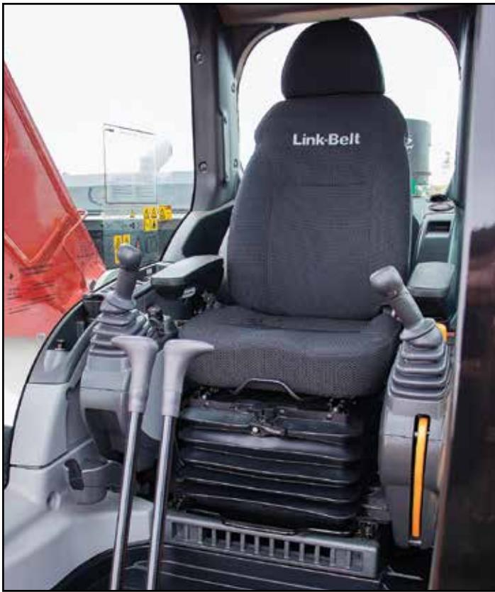
A cabine da Link-Belt 300X3E é mais robusta e espaçosa que a de todos os modelos anteriores oferecidos e tem certificação da norma ROPS e FOPS nível 1 de série, desenhada para garantir durabilidade sem reduzir o conforto do operador. Visibilidade otimizada em todas as direções.
