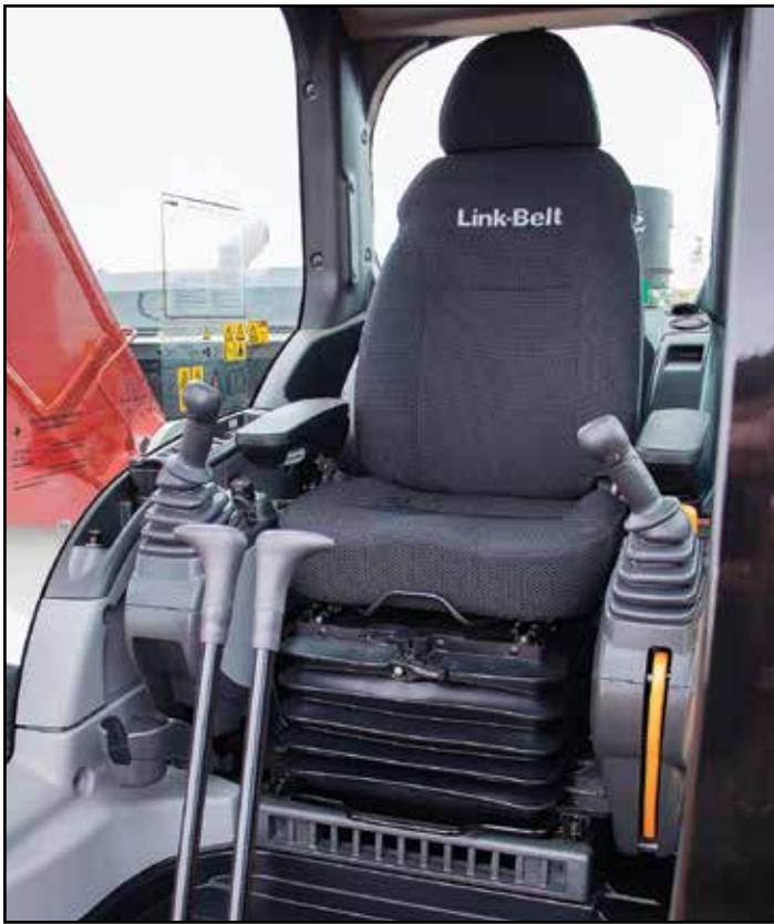
A cabine da Link-Belt série X3E é mais robusta e espaçosa que a de todos os modelos anteriores oferecidos e tem certificação da norma ROPS e FOPS nível 1 de série, desenhada para garantir durabilidade sem reduzir o conforto do operador. Visibilidade otimizada em todas as direções.
