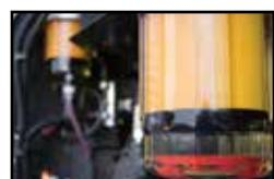
• O tanque hidráulico pressurizado reduz o risco de contaminação e cavitação da bomba
