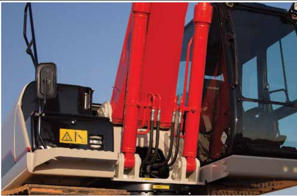
Resultado de um sistema hidráulico avançado, a 180X3E tem maior capacidade de escavação, maiores velocidades de giro e elevação simultâneas que proporcionam ciclos de trabalhos rápidos. O controle da válvula de centro aberto permite que o óleo hidráulico retorne ao tanque quando a válvula de controle está centralizada, o que proporciona uma sensação muito mais suave ao operar a máquina e elimina o excesso de pressão em todo o sistema. Isso também ajuda a economizar combustível.
