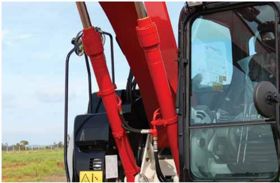
Resultado de um sistema hidráulico avançado, a 145X3E tem maior capacidade de escavação, maiores velocidades de giro e elevação simultâneas que proporcionam ciclos de trabalhos rápidos. O controle da válvula de centro aberto permite que o óleo hidráulico retorne ao tanque quando a válvula de controle está centralizada, o que proporciona uma sensação muito mais suave ao operar a máquina e elimina o excesso de pressão em todo o sistema. Isso também ajuda a economizar combustível.
