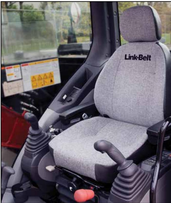
A cabine da Link-Belt série X3E é mais robusta e espaçosa que a de todos os modelos anteriores oferecidos e tem certificação da norma ROPS e FOPS nível 1 de série, desenhada para garantir durabilidade sem reduzir o conforto do operador. Visibilidade otimizada em todas as direções.
