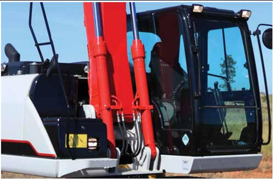
Resultado de um sistema hidráulico avançado, a 130X3E tem maior capacidade de escavação, maiores velocidades de giro e elevação simultâneas que proporcionam ciclos de trabalhos rápidos. O controle da válvula de centro aberto permite que o óleo hidráulico retorne ao tanque quando a válvula de controle está centralizada, o que proporciona uma sensação muito mais suave ao operar a máquina e elimina o excesso de pressão em todo o sistema. Isso também ajuda a economizar combustível.
